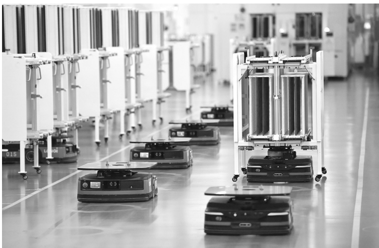
>> 光伏行业龙头企业隆基绿能科技股份有限公司通过加大研发投入、提高智能化生产水平、加强供应链保障等手段确保产能稳定。图为智能搬运机器人在太阳能电池工厂工作 邵瑞/摄
