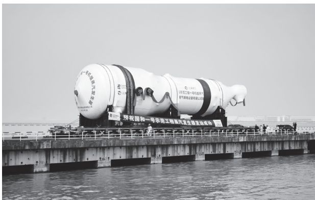
>> “国和一号”蒸汽发生器 国家电投/供图
