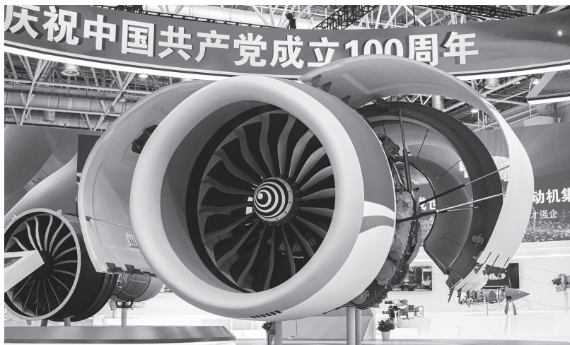
>> 航空发动机的生产制造需要用到多种稀有金属。图为中国大飞机C919使用的中国航发CJ-1000A发动机 中国航空发动机集团/供图
