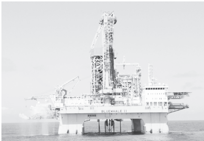
>> 由我国中集集团来福士海洋工程有限公司自主设计建造的“蓝鲸2号”，是全球最大、最先进的超深水双钻塔半潜式钻井平台，可以在全球95%的海域作业 自然资源部中国地质调查局/供图
