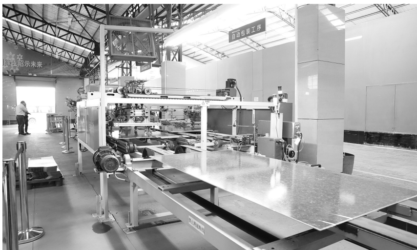
>> 在蒙娜丽莎集团股份有限公司生产车间内，从自动打包线上传来的陶瓷薄板将被机械臂抓取进行打包和码放 张宝翔/摄
