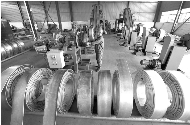
>> 江西省贵溪市以供给侧结构性改革为主线，把转型升级作为铜产业发展的着力点，打造了一批行业领先的铜精深加工企业。图为位于贵溪市的江西九星铜业有限公司的上引连铸生产线 宋振平 / 摄
