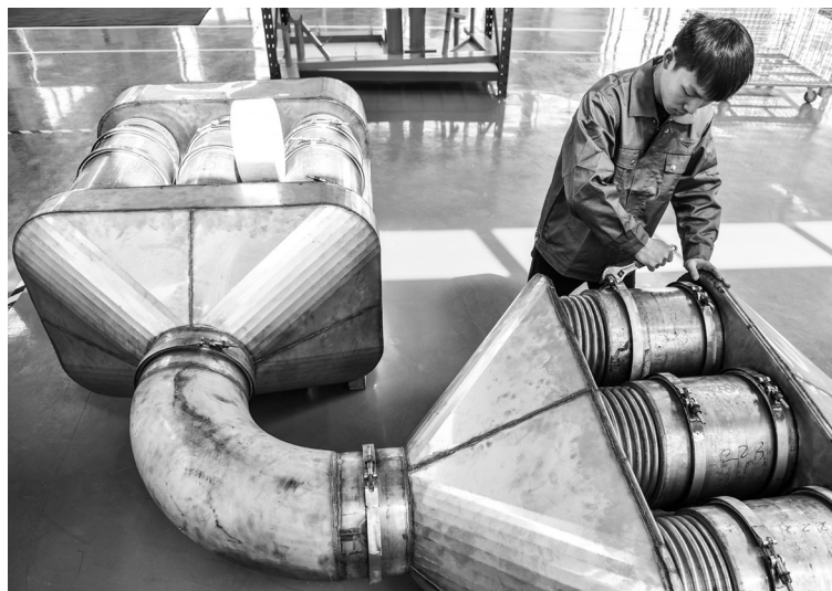
>> 河北省景县聚焦大气污染防治工作，发展绿色环保项目，促进产业升级。图为某汽车部件有限公司工人在组装重型发动机尾气后处理系统 李晓果 / 摄
