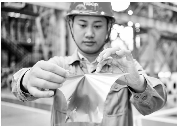
>> 2019年5月24日，太钢公司工作人员展示用手撕开0.02毫米厚的超薄带状不锈钢 曹阳/摄
