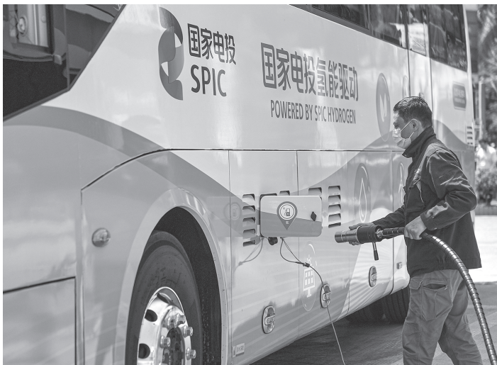
>> 2021年4月，位于海南博鳌镇的中国石化琼海银丰撬装加氢站投入运营。图为工作人员为氢燃料电池客车加注氢气 蒲晓旭/摄
