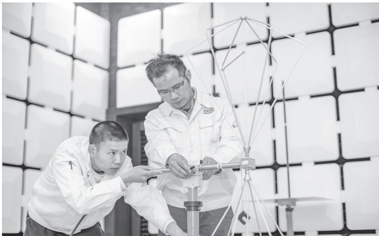
>> 近年来，重庆市大力推动制造业企业实施智能化改造，推动传统产业向终端化、智能化、精细化转型升级。图为长安汽车智能化研究院的研发人员在做电磁兼容实验 黄伟/摄
