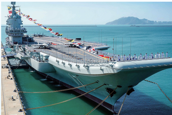
▲2019年12月17日, 山东舰在海南三亚某军港交付海军。山东舰搭载舰载机采用的仍是滑跃起飞方式
