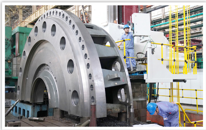
哈电集团哈尔滨电机厂有限责任公司是我国生产大、中型发电设备的重点骨干企业，创造了多个“中国第一”。图为2019年9月3日，工人在大型数控镗床上加工水轮机顶盖 王建威/摄
