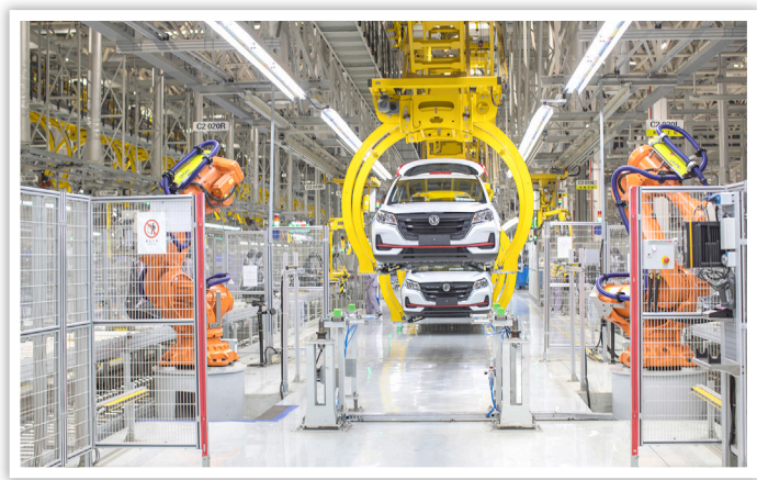
近年来，重庆大力推动制造业企业实施智能化改造。图为2021年4月2日拍摄的重庆金康赛力斯两江智能工厂总装车间的智能机械臂 黄伟/摄
