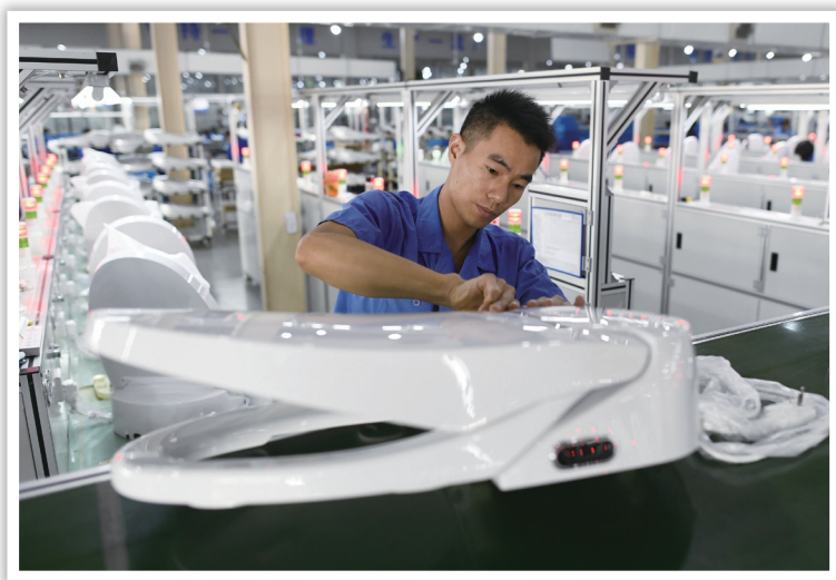
2017 年 11 月 1 日，工人在台州市西马智能科技有限公司的车间对智能马桶盖进行机芯老化测试
