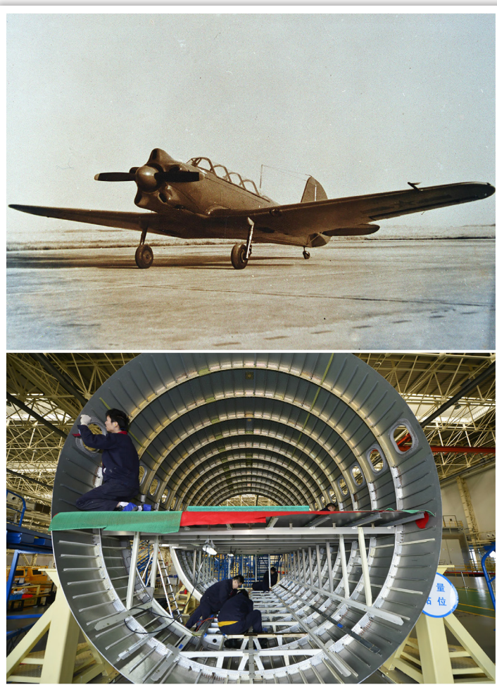
上图为国营洪都机械厂（今中航工业江西洪都航空工业集团有限责任公司）研制的新中国第一架飞机雅克-18型（初教-5）（资料照片）；下图为中航工业江西洪都航空工业集团有限责任公司工人在车间内组装国产大飞机C919机身部分 周密/摄
